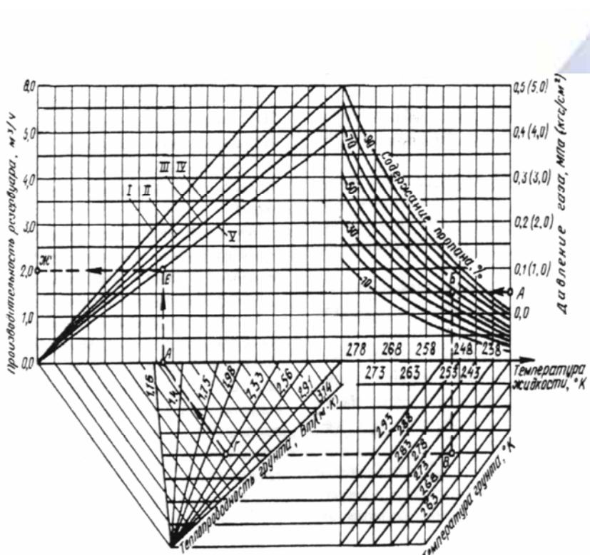
Номограмма для определения производительности резервуара сжиженного газа вместимостью 2,5 и 5 куб.м (подземного)
