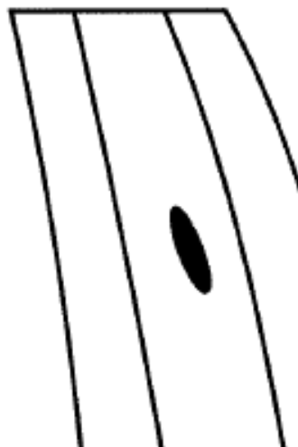
Рисунок И.5 - Часть сварочного шва с раковиной
