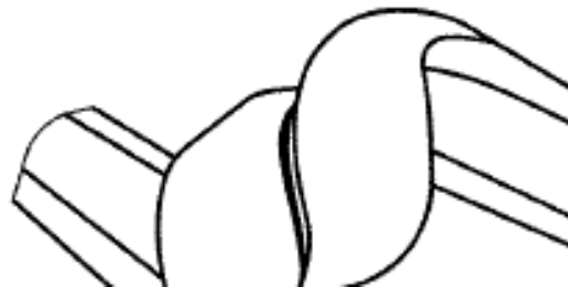
Рисунок И.7 - Испытание грата на изгиб с кручением
