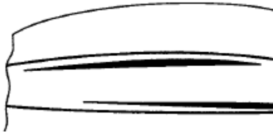
Рисунок И.6 - Часть сварочного шва с трещинами
